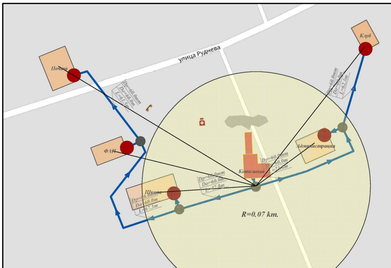
Рисунок 2.5.1 – РЭТС Муниципальной котельной
